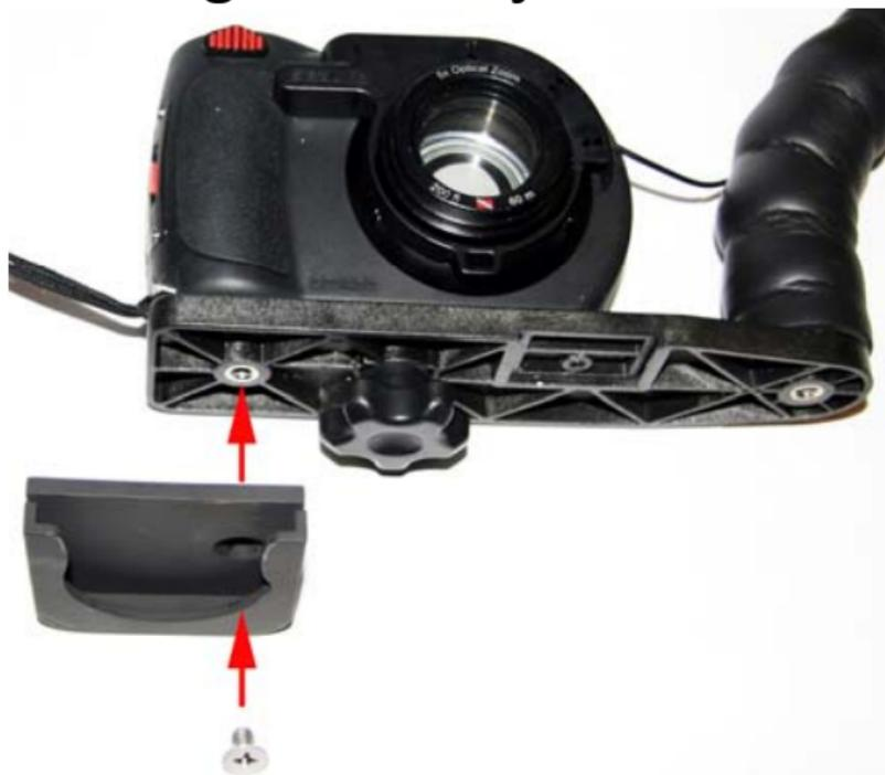
Schrauben Sie die Objektivhalterung von unten an die Blitzbefestigung an
