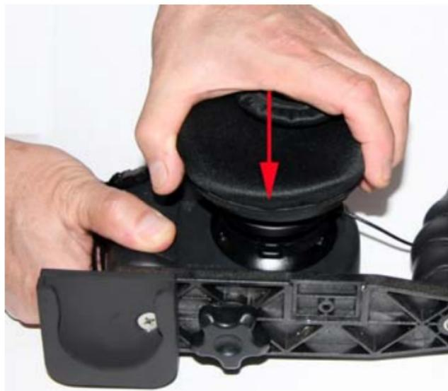
Drücken Sie das Objektiv auf den Objektivanschluss einer SeaLife-Unterwasserkamera der “DC”-Serie. Das Objektiv kann sowohl an Land als auch unter Wasser aufgesetzt werden. Setzen Sie es unter Wasser auf,
