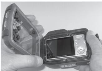
Paso 4: Cierre la carcasa y presione el pestillo como se muestra para asentar con firmeza el pestillo en la carcasa.
