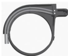
Paso 2: Coloque el adaptador Flash Link alrededor del objetivo y presione hasta que encaje fijo en su lugar. Hay dos mecanismos pequeños de enclavamiento situados en el borde exterior del adaptador que deberían encajar bien en la carcasa de la cámara. Asegúrese de que el adaptador esté orientado de manera que quede alineado con el hueco de la ventana del flash interno.
