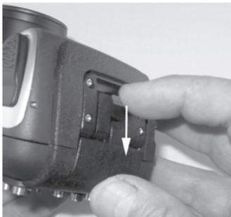
Paso 2: Abra el pestillo hasta el máximo para levantar y soltar el pestillo de la carcasa.
