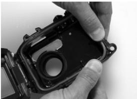
**Fase 4: Chiudere con cura l'involucro per collocare saldamente in sede l'O-ring e aprire nuovamente l'involucro per assicurarsi che l'O-ring sia completamente in sede nella scanalatura. NON ingrassare l'O-ring.**
