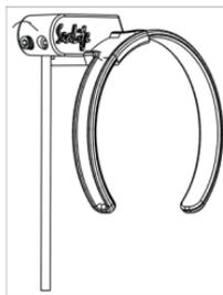
**Paso 3: Coloque el adaptador alrededor del puerto de la lente de la carcasa para que quede asentado en el hueco de la ventana del flash.**
