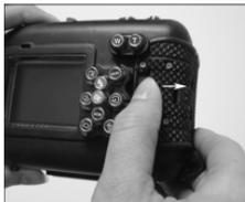
**Paso 2: Abra el pestillo hasta el máximo para levantar y soltar el pestillo de la carcasa.**
