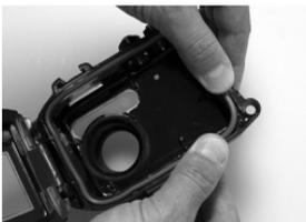
**Paso 4: Cierre con cuidado la carcasa para asentar con firmeza el anillo con forma de O y abra de nuevo la carcasa para comprobar que el anillo con forma de O está completamente asentado en la ranura. NO engrase el anillo con forma de O.**
