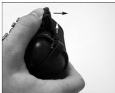
**Paso 3: Abra la carcasa como se muestra para que la cámara interna no se caiga.**
