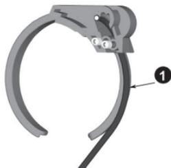
Schritt 2: Ziehen Sie die Schraube mit dem kleinen Schraubenzieher so fest an, bis Sie einen leichten Widerstand fühlen. Überdrehen Sie nicht die Schraube! Ziehen Sie vorsichtig am Kabel, um zu prüfen, ob es fest sitzt.
