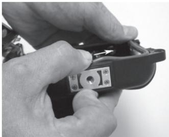
Schritt 2: Ziehen Sie den Dichtring vorsichtig aus der Rille heraus.
