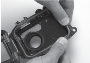
Schritt 4: Schließen Sie das Gehäuse vorsichtig, und prüfen Sie, ob der Dichtring vollständig in der Rille sitzt. Der Dichtring darf NICHT eingefettet werden.
