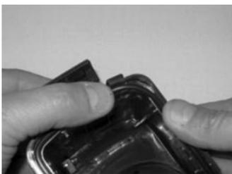
Punto 4: Chiudere con cura l'involucro per collocare saldamente in sede l'O-ring e aprire nuovamente l'involucro per assicurarsi che l'O-ring sia completamente in sede nella scanalatura. NON ingrassare l'O-ring.
