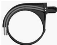
Punto 2: Applicare l'adattatore Flash Link attorno all'obiettivo e premere fino al blocco in posizione. Ci sono due piccoli meccanismi di blocco posti sul bordo esterno dell'adattatore che dovrebbero fissarsi sulla custodia della fotocamera. Verificare che l'adattatore sia orientato in modo da essere allineato con la finestra incassata del flash interno.
