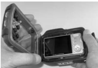
Punto 4: Chiudere l'involucro e premere in giù il fermo per collocare saldamente in sede il fermo nell'involucro.
