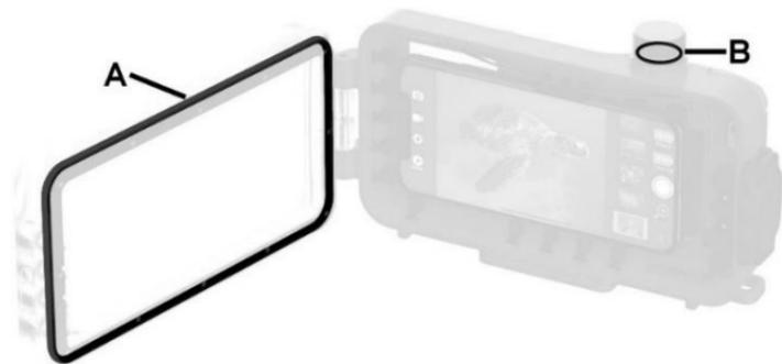
Dichtungsringe entfernen – Verwenden Sie zum Abheben und Entnehmen der Hauptdichtungen aus der Nut das Werkzeug zum Entfernen der Dichtungsringe oder eine Kreditkarte.
