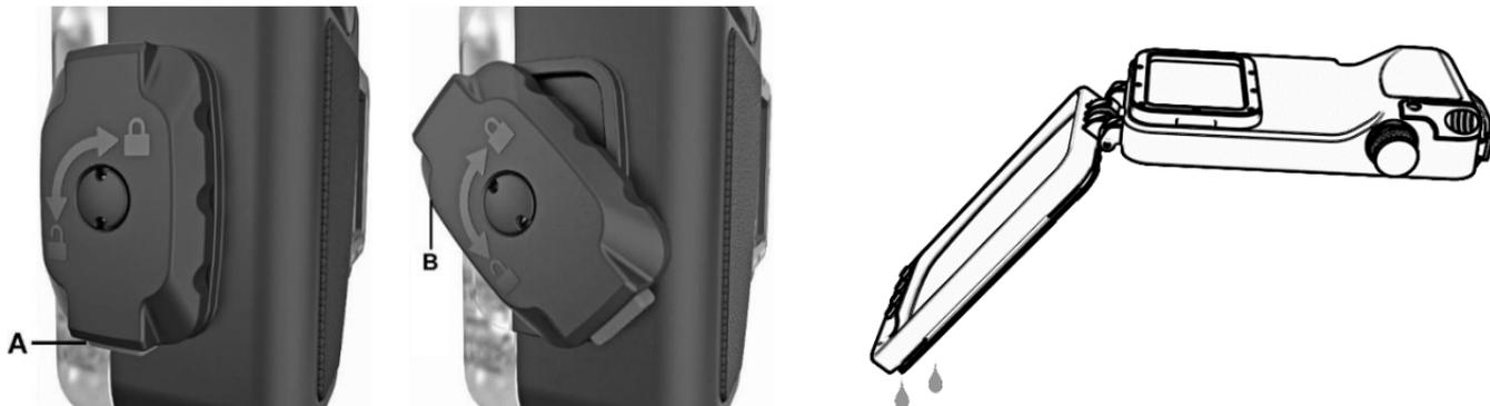
**Wichtig:** Lassen Sie vor dem Öffnen des Gehäuses den Luftdruck im Innenraum ab. Um den Vakuumdruck abzulassen, schrauben Sie die Kappe am Vakuum-Checkport ab und schieben Sie das gelbe Einweg-Gummiventil mit den Fingerspitzen zur Seite. Sie hören, wie der Druck entweicht.
