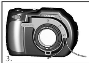
1. Drücken Sie das optische Kabel in eine der Rillen, sodass es fest sitzt. Das Ende des Kabels muss zum Blitz der Kamera zeigen. Es darf aber nicht über den Adapter hinausreichen. Der Adapter hat zwei Rillen, sodass Sie bei Verwendung von zwei Blitzern ein weiteres Kabel befestigen können.
