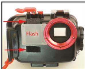
**Schritt 2:** Entfernen Sie die Schutzfilme und kleben Sie die Klettbandstreifen fest über und unter dem Blitzfenster des Unterwassergehäuses auf. Stellen Sie sicher, dass das Gehäuse sauber und trocken ist.
