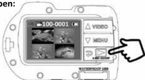
2. Verwenden Sie die Tasten AUF ( $\Delta$  VIDEO) oder AB ( $\nabla$  MENU) für das Scrollen durch die Miniaturansichten.
