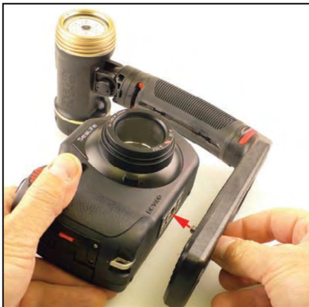
Allineare la fotocamera subacquea alla vite di montaggio della torcia e serrare a mano.
