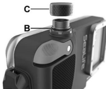
5. Ponga un poco de silicona para junta tórica en la yema del dedo. Aplique una capa delgada de lubricante de silicona a la superficie expuesta de la junta tórica principal y de la junta tórica del puerto de comprobación de vacío. Use la yema del dedo para esparcir uniformemente el lubricante sobre las superficies expuestas de las juntas tóricas. **Solo es necesaria una capa fina de lubricante.**
