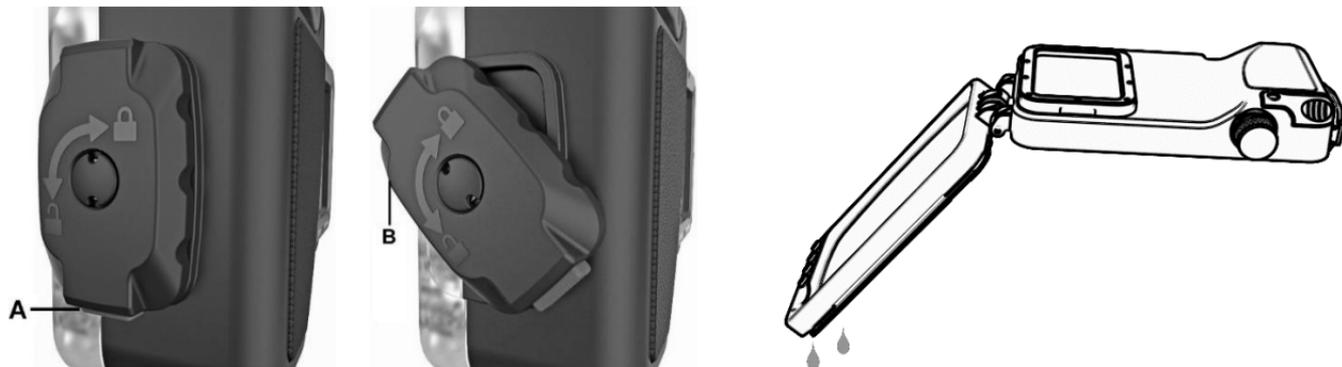
**Importante:** Libere la presión de vacío interna antes de abrir la carcasa. Para liberar la presión de vacío, desenrosque la tapa del puerto de control de vacío y use la yema del dedo para mover hacia los lados la válvula unidireccional de goma amarilla. Escuchará cómo se libera la presión.
