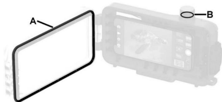
Retirer les joints toriques - Utilisez l'outil de retrait du joint torique ou une carte de paiement pour le soulever et le retirer de la rainure.
