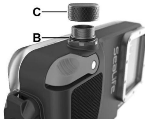
4. Déposez une petite quantité de silicone pour joint torique sur le bout de votre doigt. Appliquez une fine couche de lubrifiant pour silicone sur la surface exposée du joint torique principal et celle du joint torique du contrôle de vide. Avec le doigt, étalez uniformément le lubrifiant sur les surfaces exposées des joints toriques. **Une fine couche de lubrifiant suffit.**
