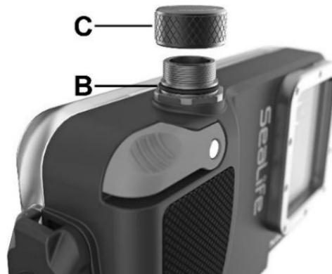
4. Mettere una piccola porzione della guarnizione O-ring in silicone su un polpastrello. Applicare un leggero strato di lubrificante per silicone sulla superficie visibile dell'O-ring principale e dell'O-ring dell'attacco per il controllo del vuoto. Usando il polpastrello, spalmare uniformemente il lubrificante sulle superfici visibili della guarnizione O-ring. **È sufficiente utilizzare un sottile strato di lubrificante.**
