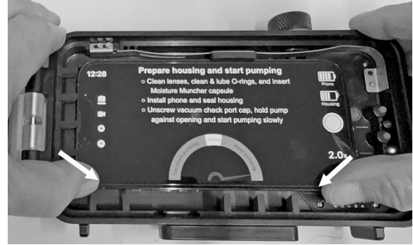
Druk vervolgens naar beneden om de telefoon vast te zetten tegen de greeplijpjes
