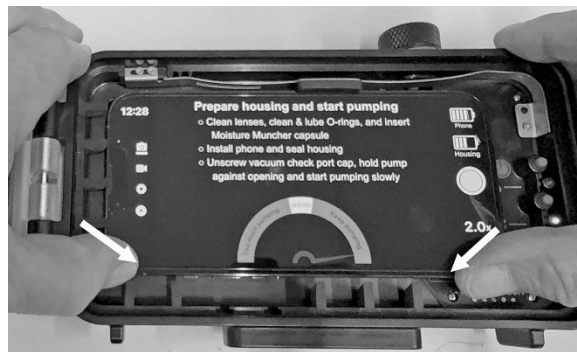
Appuyez ensuite pour fixer le téléphone contre les pattes de prise
