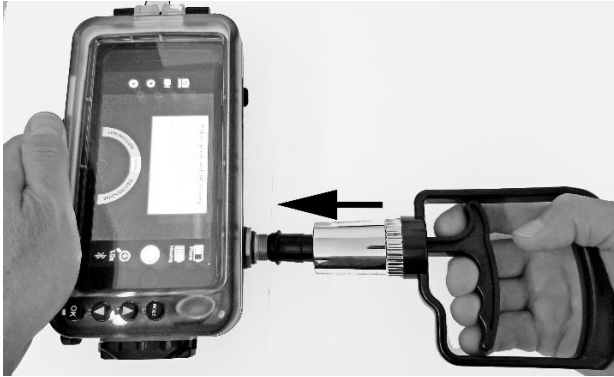
Handpumpe gegen den Vakuum-Prüfanschluss drücken
