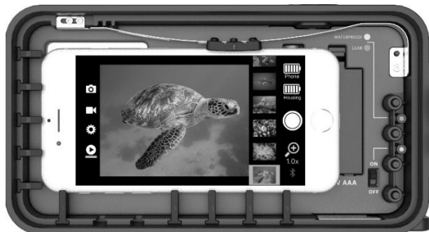
Teléfono pequeño con lengüetas de goma grandes instaladas
