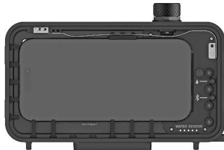
Durch Vergrößern der Gummigreifer verschwindet der Spalt
