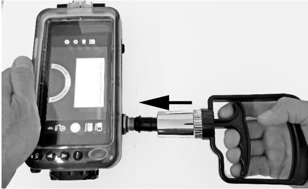
Handpumpe gegen den Vakuum-Prüfanschluss drücken
